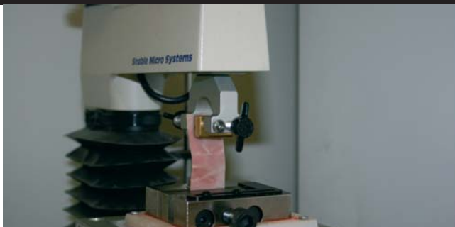
! Foto 4: Test de tensión mediante el Texture Analyser TA.TX2 (Stable Micro System Ltd) ! Photo 4: Tensile test with the Texture Analyser TA.TX2 (Stable Micro System Ltd)
